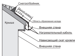
Рис. 3 Вид сбоку на крышу с установленной системой антиобледенения.
